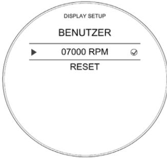
Einstellen des Drehzahl-Schwellwerts für die Schaltanzeige (in U/min):
