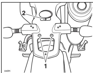
1. Untere Befestigungen hinterer Kotflügel
