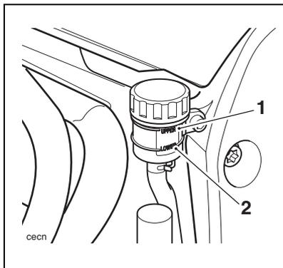
1. Hinterer Bremsflüssigkeitsbehälter, obere Markierungslinie
