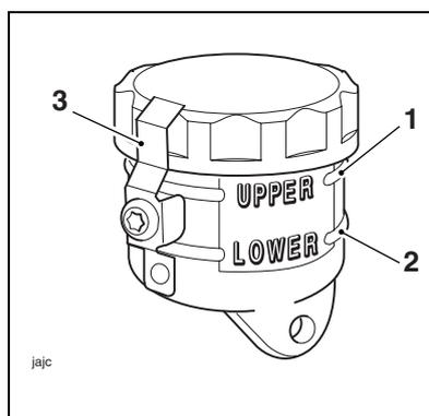
1. Vorderer Bremsflüssigkeitsbehälter, obere Markierungslinie
