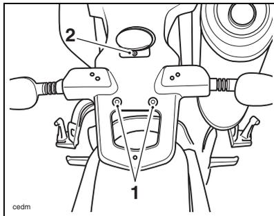
1. Untere Befestigungen hinterer Kotflügel
