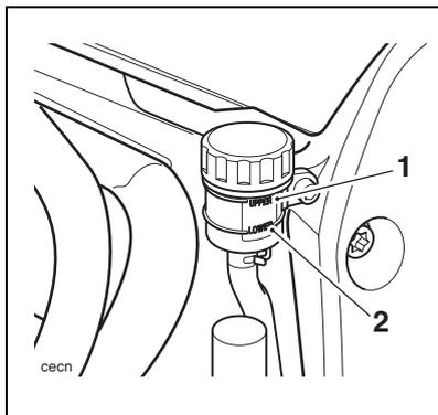
1. Hinterer Bremsflüssigkeitsbehälter, obere Markierungslinie
