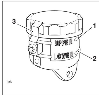
1. Vorderer Bremsflüssigkeitsbehälter, obere Markierungslinie
