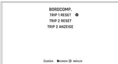
Durch Auswahl von TAGESKILOMETER 1 ZURÜCKSETZEN bzw. TAGESKILOMETER 2 ZURÜCKSETZEN kann der entsprechende Tageskilometerzähler manuell oder automatisch konfiguriert werden. Das Einrichtungsverfahren ist dasselbe für beide Tageskilometerzähler.
