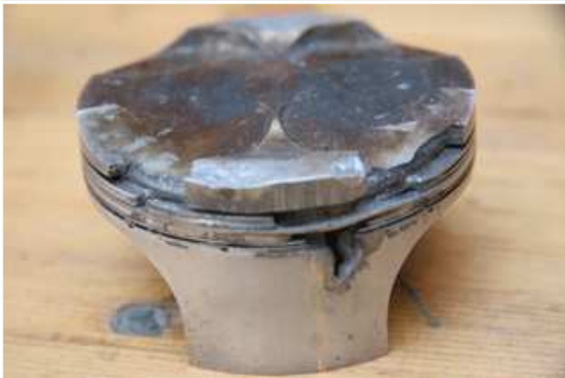
Einer von sechs Kolben, die's nicht überlebt haben
